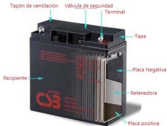
Figura 1: Construcción de la Batería
